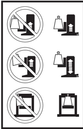
Los pasadores con las cadenas deben estar siempre situados en los pies de soporte para evitar que se muevan durante la elevación de la carga.
