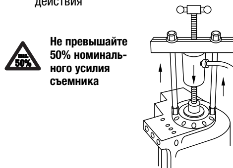
Рис. 3. Работа съемника-хомута в режиме тянущего действия
