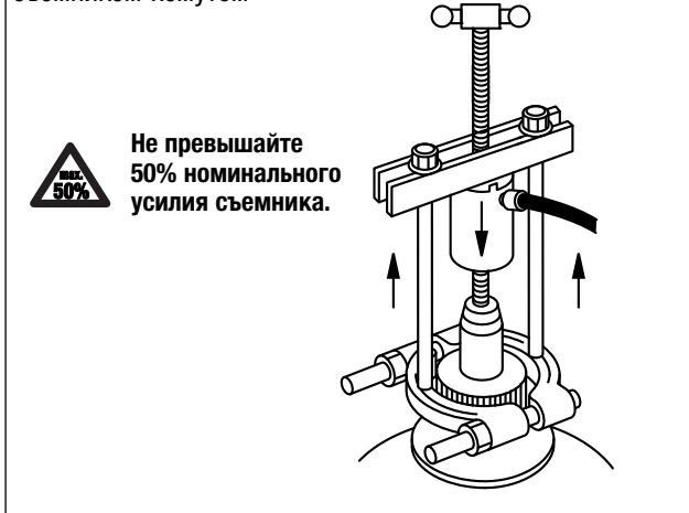
Рис. 4. Насадка для снятия подшипников со съемником-хомутом
