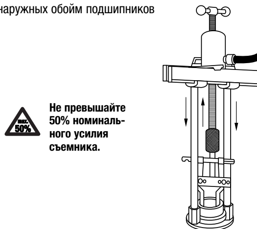
Рис. 2. Съемник-хомут с насадкой для демонтажа наружных обойм подшипников
