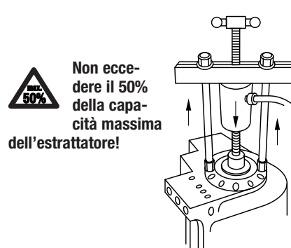
Illustrazione 5 - Calettare con estrattore a tiranti
