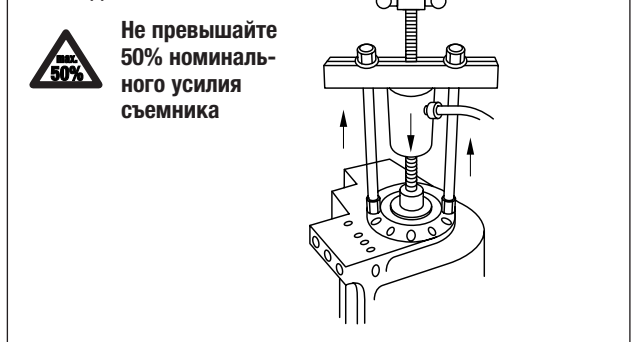
Рис. 5. Работа съемника-хомутом в режиме тянущего действия
