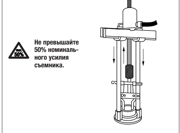
Рис. 4. Съемник-хомутом с насадкой для демонтажа наружных обойм подшипников
